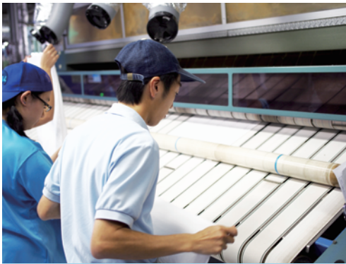
汚れがないか目視で検査中
